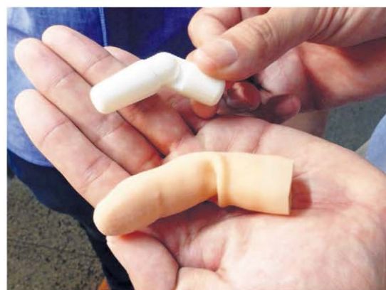
将机械（上）放入用三维科技制作的假肢内，就能为失去手指的人制作一个结合美观与实用性于一体的假肢手指。
